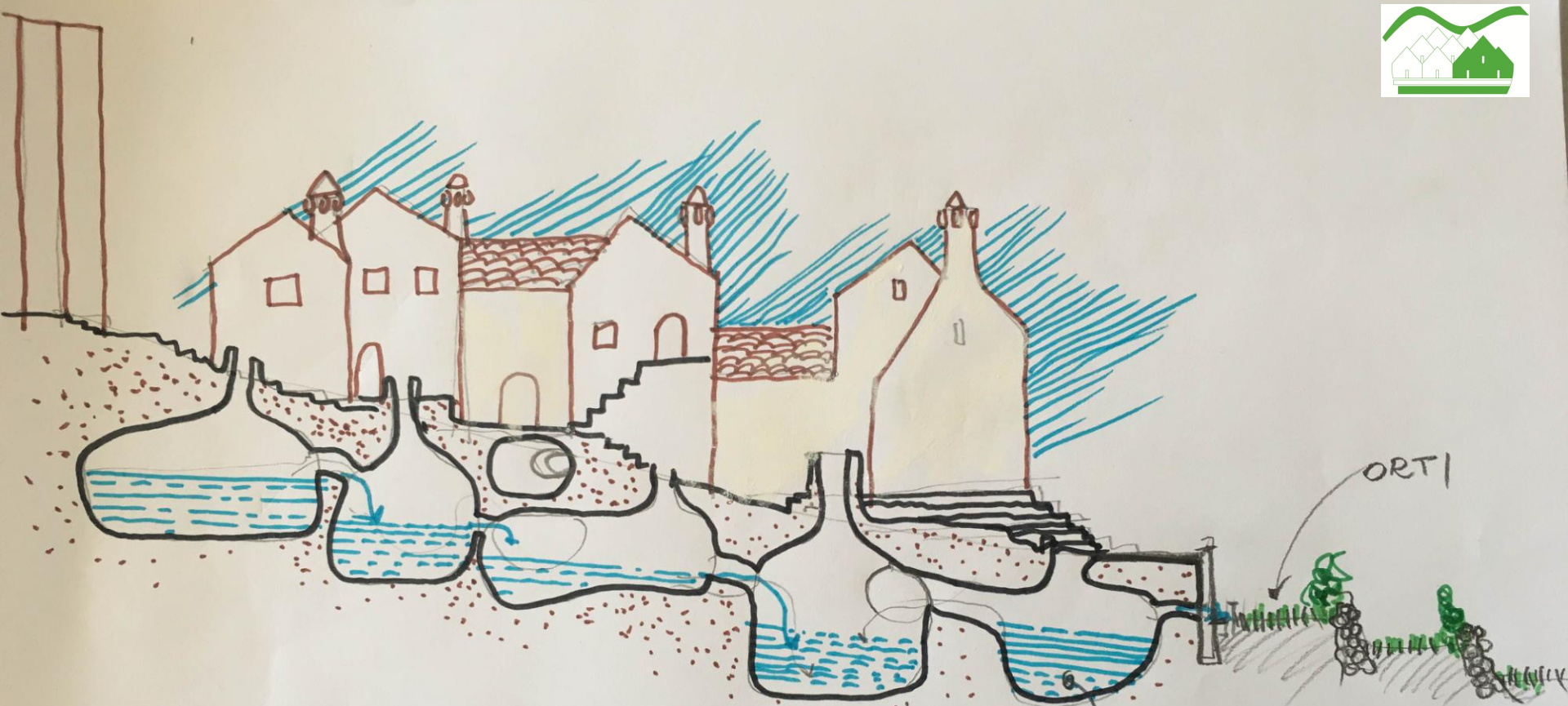
IL SISTEMA DELLA RACCOLTA DELLE ACQUE
